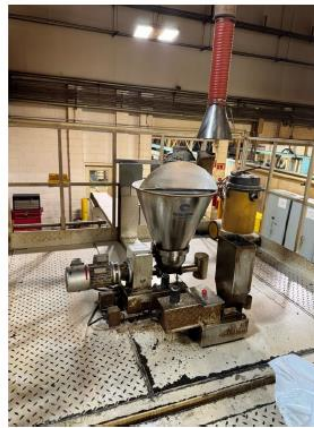
Foto 1 – Da esquerda para a direita: Painel de controle para Misturador, Misturador e Dosadores Volumétricos.
