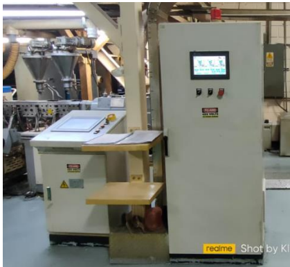
Foto 2 – Painel de controle do Alimentador e da Extrusora.
