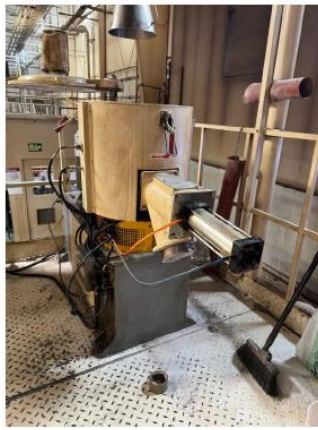
Foto 1 – Da esquerda para a direita: Painel de controle para Misturador, Misturador e Dosadores Volumétricos.
